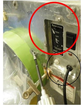
図 4.7.55 電源コード取り付け部 ダクト接続口
