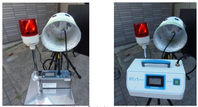
図4.14.18 排気ダクト内の測定時に警告灯を設置した例
