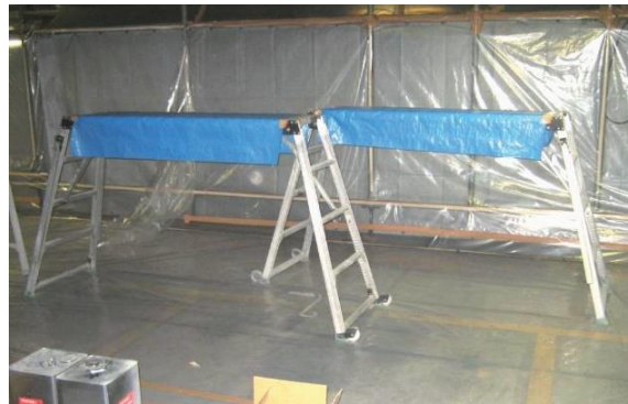
図 4.7.57 可搬式作業台の例
