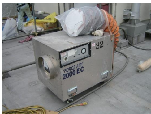
図 4.7.35 集じん・排気装置の例
