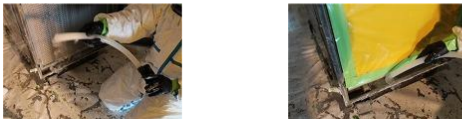
図 4.7.87 スモークテスターによる確認
